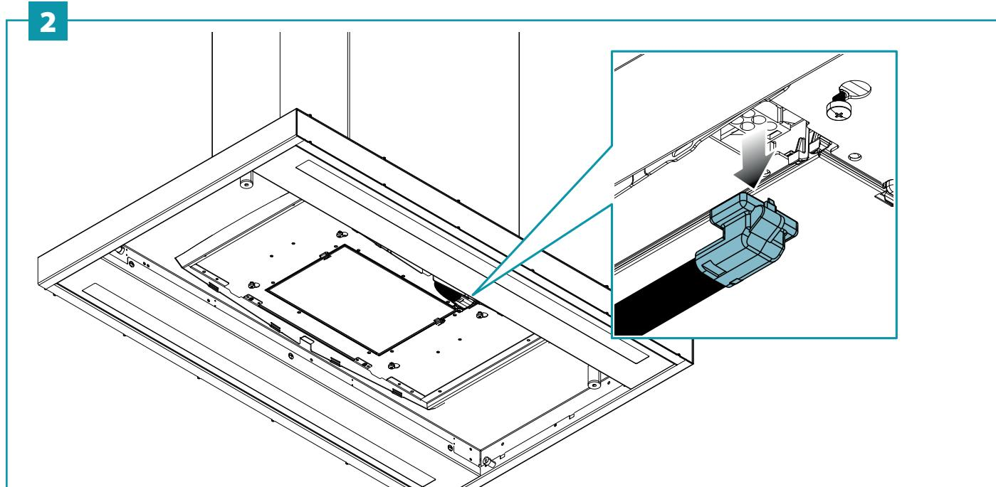
IT - Operazioni preliminari: smontaggio camera motore (3).
