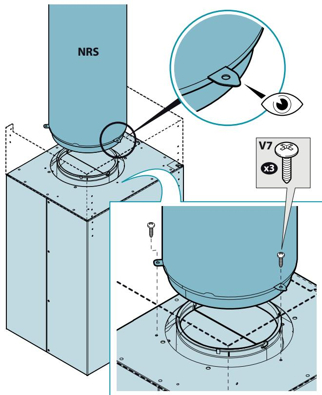
**IT** - Installazione a soffitto e controsoffitto. Fissaggio traliccio superiore a soffitto (7). Fissaggio traliccio inferiore e camera motore (8).
