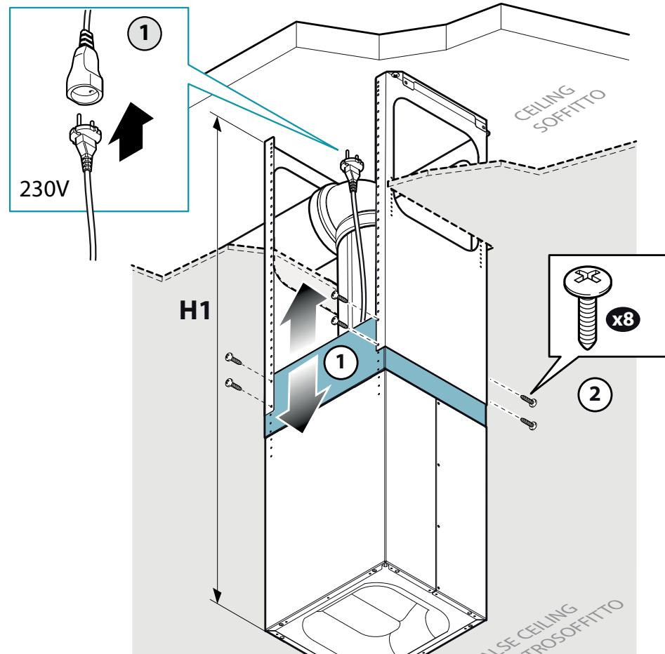
**IT** - Installazione con soffitti bassi. Fissaggio traliccio inferiore e camera motore al soffitto (9). Installazione tubo NRS (10).
